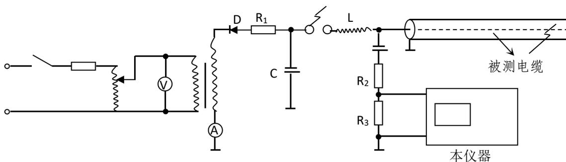
图 9 冲击高压法测试原理图
